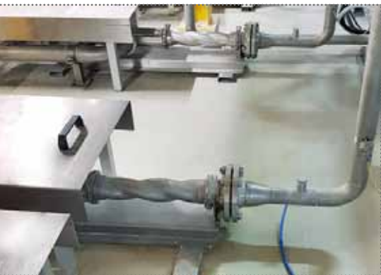
WANGEN MX im Einsatz zur Förderung abrasiver Pasten.
