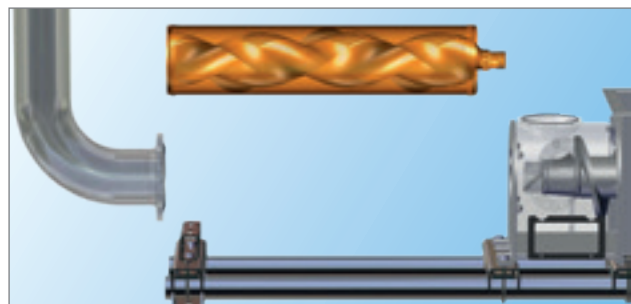
Schritt 3: Stator und Rotor nach vorne bewegen und aus dem Gehäuse herausziehen.
