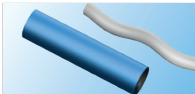
Schritt 4: Stator vom Rotor abziehen. Fertig.
