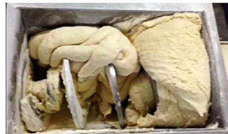
■ Abb. 3: Sonderanwendungen wie das Inline-Mischen von Sauerteigen sind für das Wangen Variotwin NG-Aggregat ebenfalls kein Problem.
