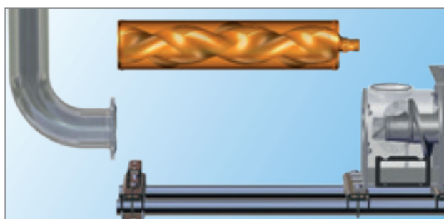
Шаг 3: Потяните статор и ротор вперед и вытащите их из корпуса насоса
